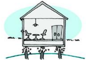
Grondwaterpeil te laag: paalrot
